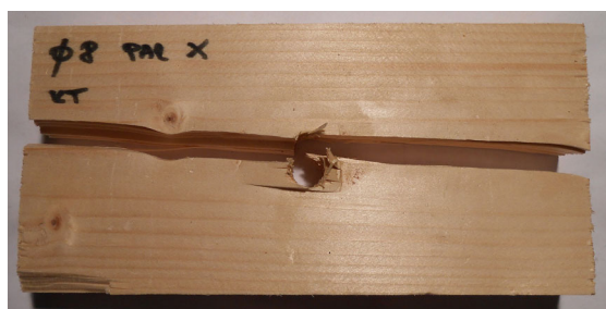
otvor \varnothing = 8 mm - parenie 0 min.
