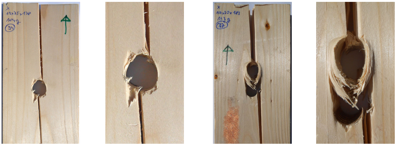
Obr. 2 – Porušenie okolia spoja – zaťaženie v smere vlákien dreva (vľavo – nemodifikovaná vzorka a detail porušenia, vpravo – modifikovaná vzorka a detail porušenia)
