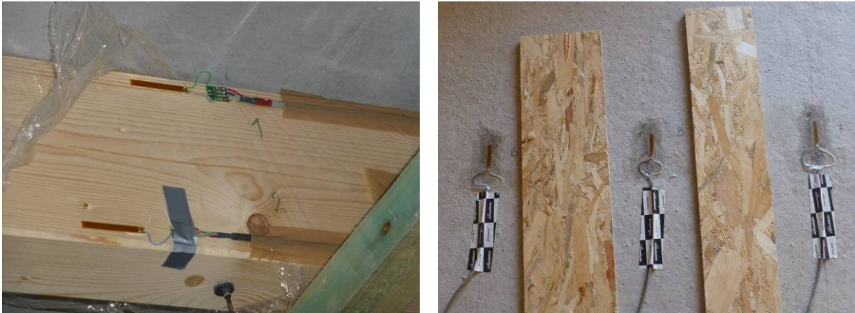
Obr. 6 Meranie pomerných pretvorení na okraji drevených trámov (vľavo) a na hornom povrchu betónovej dosky (vpravo)
