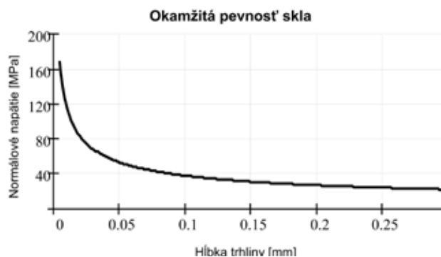
Obr. 4 Princíp zvýšenia ťahovej pevnosti skla kalením [1]
