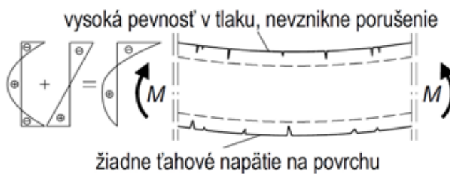
Obr. 4 Princíp zvýšenia ťahovej pevnosti skla kalením [1]
