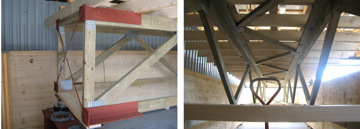
Obr. 5 – Skúmaná dvojica nosníkov a vodorovné vystužovadlo v rovine horných pásov
