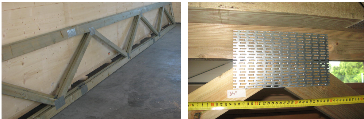
Obr. 1 – Skúšobné vzorky, celkový pohľad a detail prípoja
