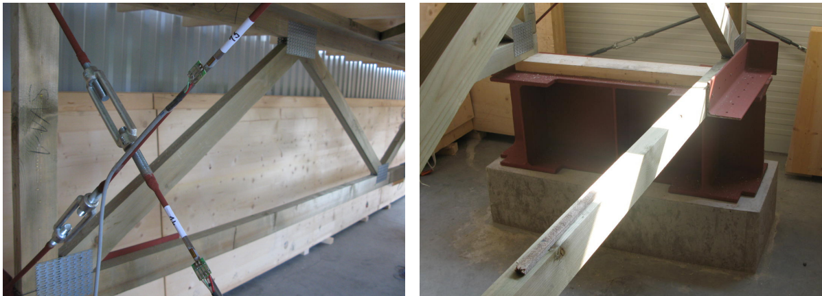
Obr. 6 – Zvislé oceľové vystužovadlo a koncová podpera skúšobných vzoriek
