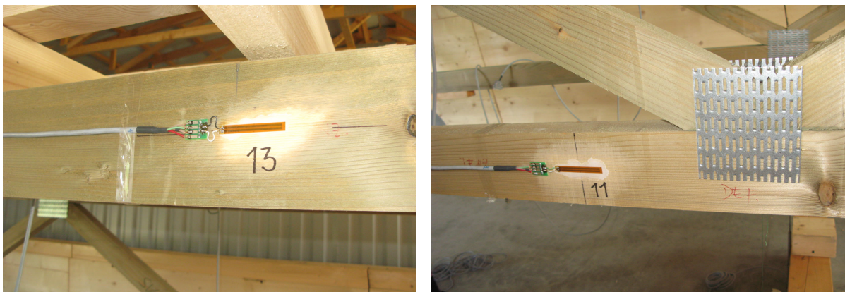
Obr. 11 – Osadenie tenzometrov na skúšobnej vzorke
