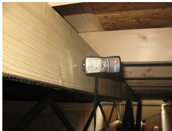
Obr. 3 – Meranie vlhkosti prvkov skúšobnej vzorky (vzorka B)
