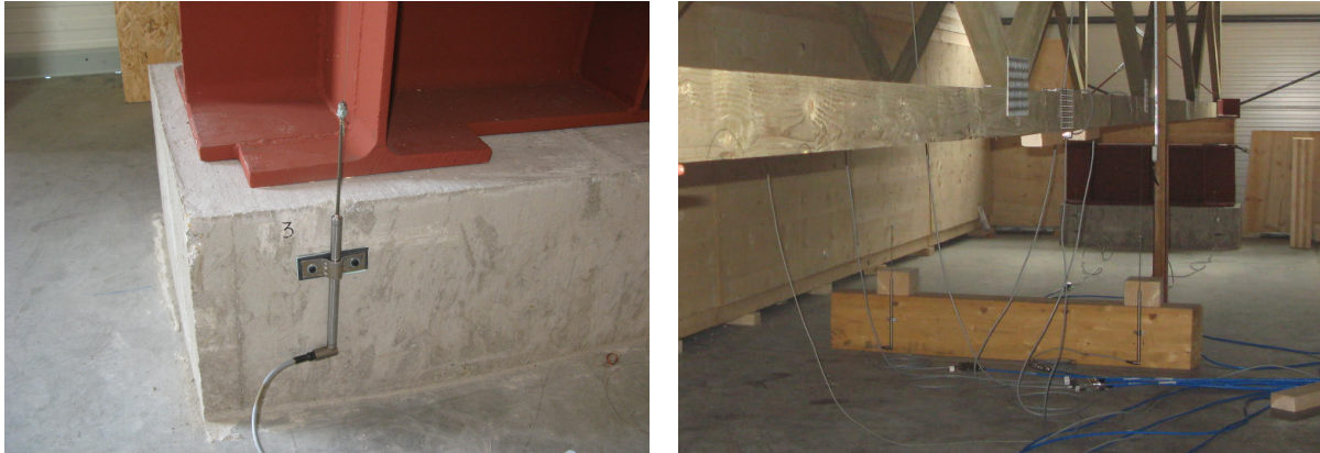
Obr. 4 – Meranie deformácií v mieste podpory a v strede rozpätia nosníka
