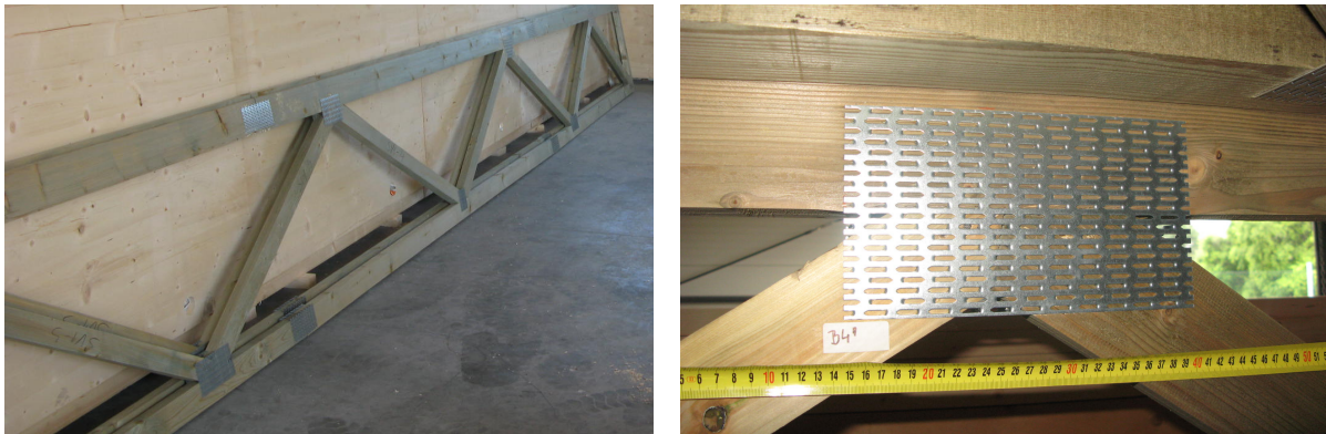
Obr. 1 – Skúšobné vzorky, celkový pohľad a detail prípoja
