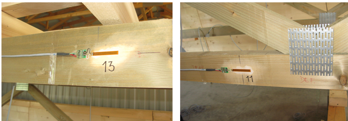
Obr. 6 – Osadenie tenzometrov na skúšobnej vzorke
